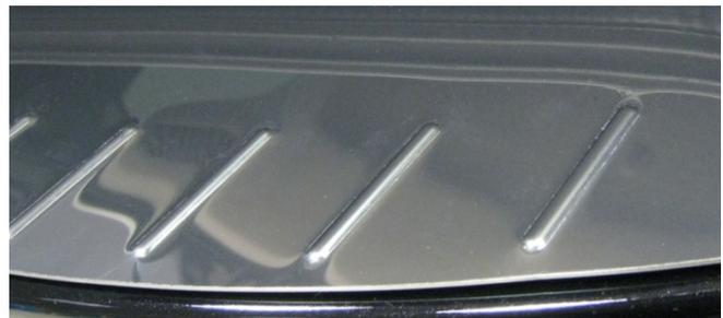
Aluminium „Inox“ erinnert optisch an gebürstetes Edelstahl. Diese Oberfläche wird durch ein transparentes Eloxierverfahren erreicht. Das Material ist oberflächenhart, sehr pflegeleicht und witterungsbeständig. Stärke: 1,5mm
